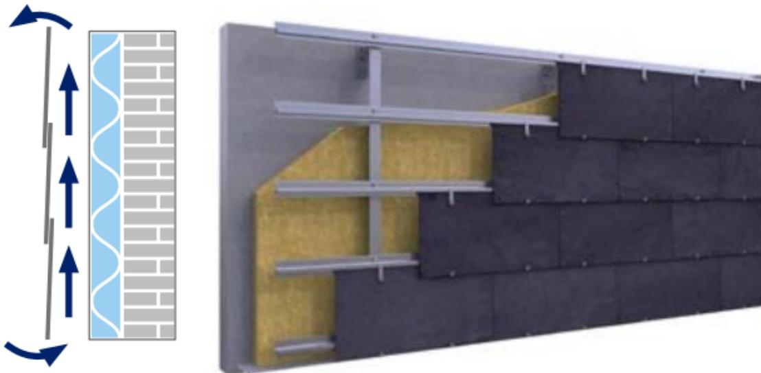
Shema ventilirane fasade od prirodnog kamena s vidljivim učvršćenjima.
